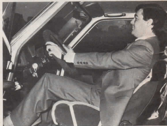
Foto 6. Incorrecta. Muy atrás
